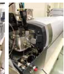
液体クロマトグラフ 質量分析計 島津製作所 LC/MS-IT-TOF プロテオーム解析
